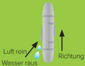
Das Siphonsicherheitsventil muss höher angebracht werden als der Wasserstand im Reservoir ist.
